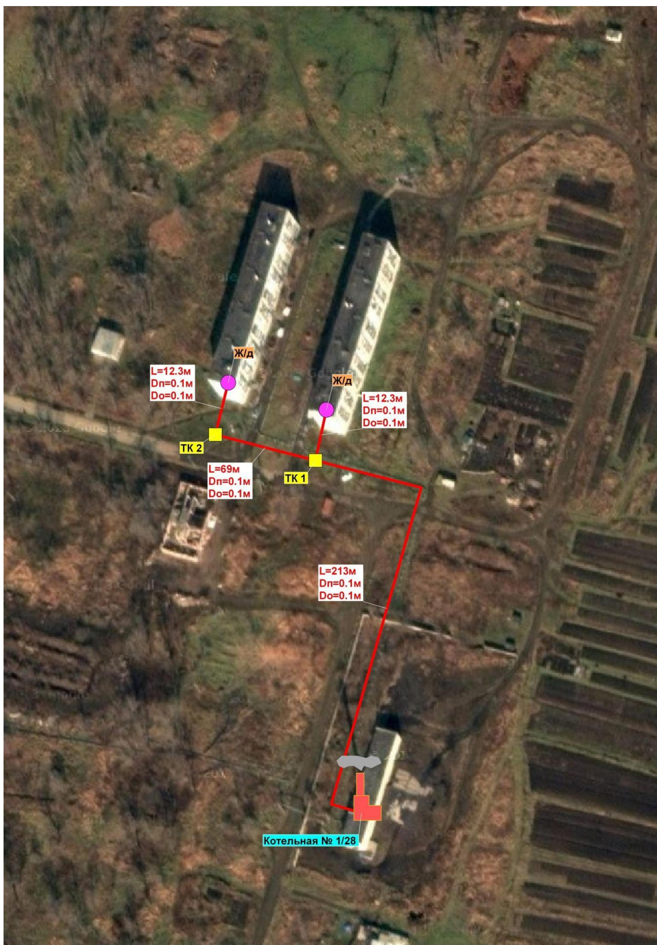
Рис. 2.4 – Схема теплоснабжения села Кремово от котельной № 1/28
